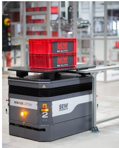
Abbildung 8: Flurförderfahrzeug mit schwingend gelagerten Antriebsrädern © SEW-EURODRIVE GmbH & Co KG
