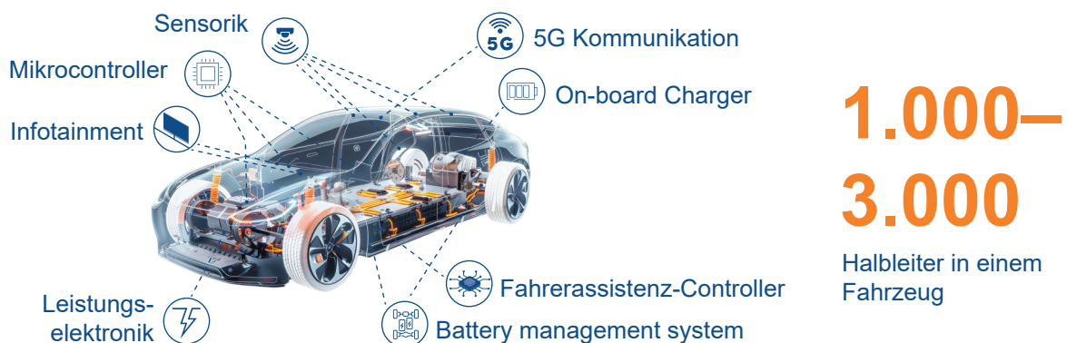
Abb. 1.6: Übersicht der Halbleiteranwendungen in einem Elektroauto
